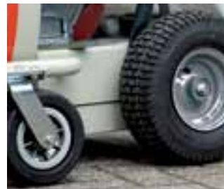
Antriebsräder Geländegängig dank sehr schwerer Bockrollen und breiter Profile bei Lenkrollen und Antriebsrädern
